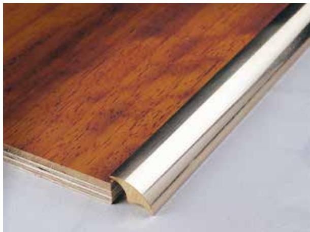
La caractéristique des profilés VARIOTEC DC est de pouvoir s'adapter aux différentes dénivellations, grâce à la forme spéciale du profilé en croissant qui, lorsqu'il est tourné, s'adapte aux épaisseurs de 7 à 14 mm, tout en conservant une surface visible élégante. Le profilé est installé par l'intermédiaire d'un adhésif à appliquer sur place, remplaçant complètement la cavité créée entre le sol et le profilé.
